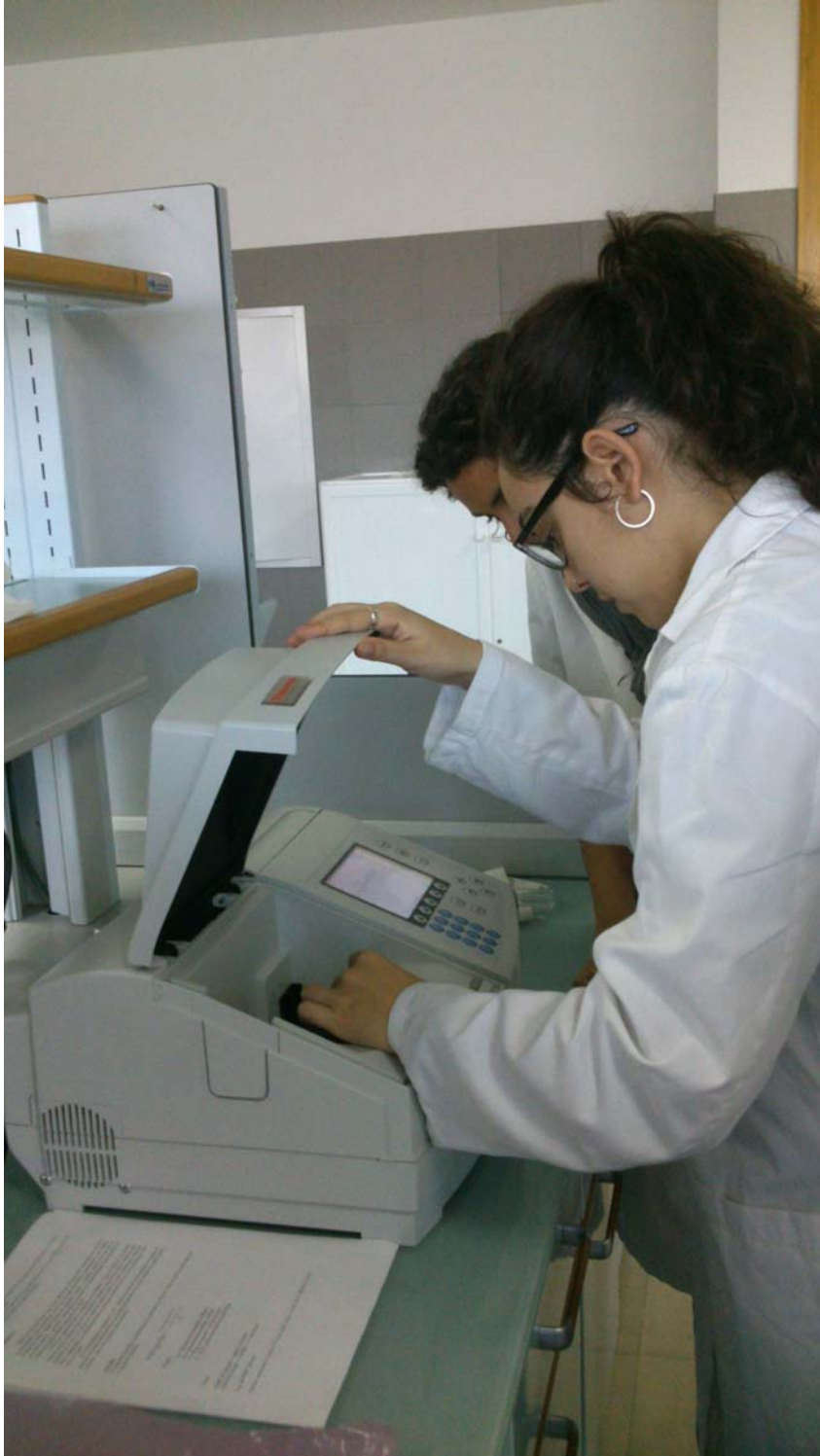
Figura 6. Análisis de HMF en miel mediante espectrofotetría UV Laboratorios de la Facultad de Química de la Universidad de Sevilla.
