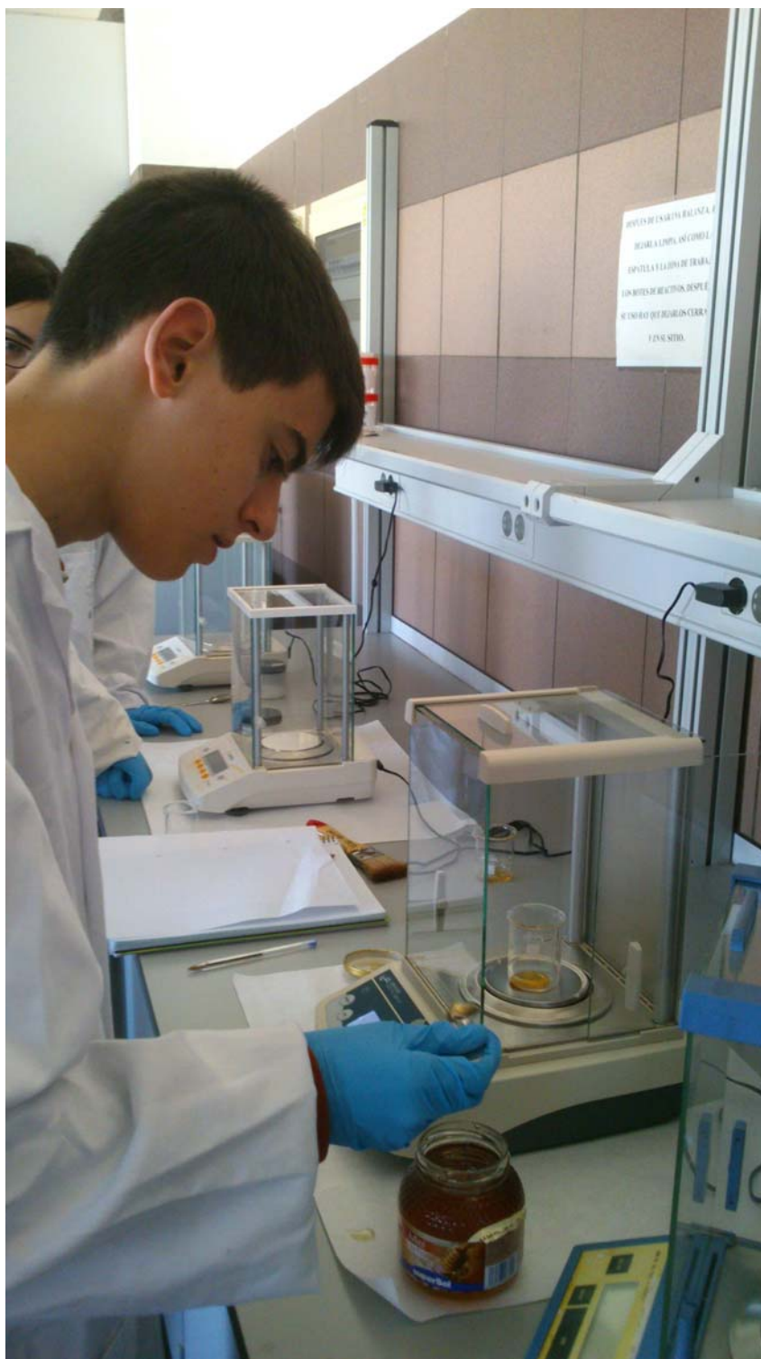
Figura 4. Pesada de las muestras de miel en balanza analítica. Laboratorios de la Facultad de Química de la Universidad de Sevilla.
