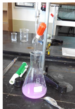
Imagen 5.3.1.2 Valoración ácido-base completada. Las disoluciones han reaccionado y la fenolftaleína ha adquirido un color rosáceo.
