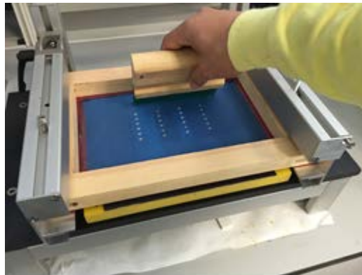
Figura 4. Ilustración del equipo de screen-printing para el depósito de películas de \text{TiO}_2
